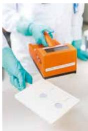
**Porte-source** pour sources alpha électro-déposées (type EAS) utilisées pour les balises EDGAR.
