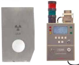
Sources  $^{241}\text{Am}$  pour balises aérosol alpha et bêta (balises ICAM)
