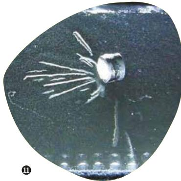
Source radioactive dans une chambre à brouillard
