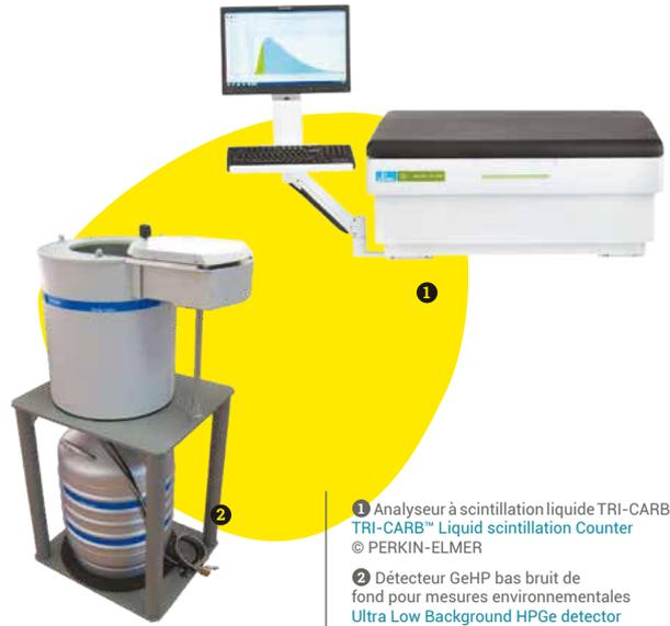
① Analyseur à scintillation liquide TRI-CARB™
