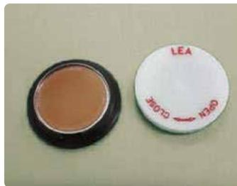
Source de diamètre actif 40 mm déposée dans la coupelle client de diamètre 47 mm
