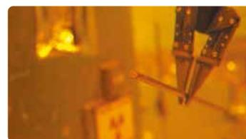
Télémanipulation de sources de rayonnement gamma utilisé pour étudier le comportement de matériaux sous irradiation © IRSN Saclay
