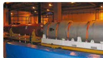
Ligne de fabrication des crayons de démarrages des réacteurs nucléaires de type EPR © LEA
